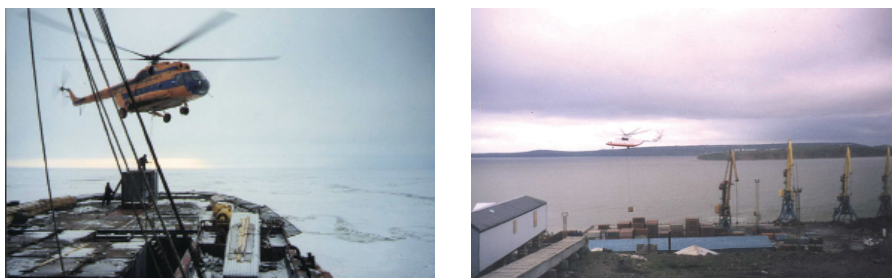
Рис. 8. а) Выгрузка контейнеров УУК-5 с НЭС «Михаил Сомов» на внешней подвеске вертолета «Ми-8»; б) выгрузка контейнеров УУК-5 на внешней подвеске вертолета «Ми-26», порт Анадырь
