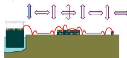
Рис. 2. Укрупненные операции на морском терминале
