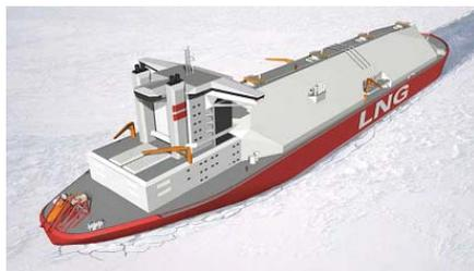
Рис. 3. Газовоз СПГ ледового плавания двойного действия. Проектировщик — Aker Arctic
