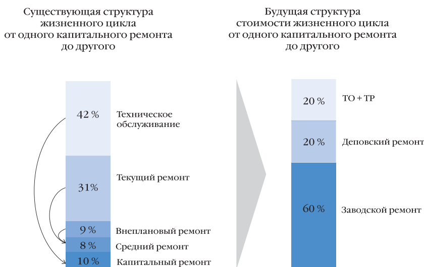
Рис. 2. Повышение надежности локомотива за счет усиления заводского ремонта в счет будущей экономии расходов в эксплуатации
