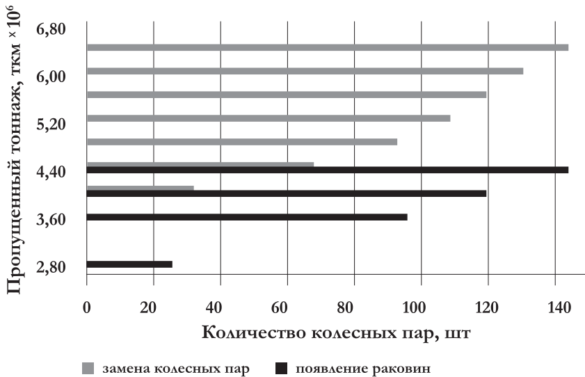
Рис. 2. Замена колесных пар ПМ-600 и появление дефектов на поверхности катания
