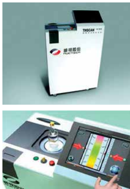
Рис. 2. Инспекционная система для обнаружения легковоспламеняющихся жидкостей THSCAN LS8016. Технические характеристики: габариты – 800 × 500 × 1300 мм; размеры досматриваемого объекта – 160 × 500 мм; количество операторов – 1; длительность сканирования одного объекта – 5 с; потребляемая мощность – 0,4 кВт.
