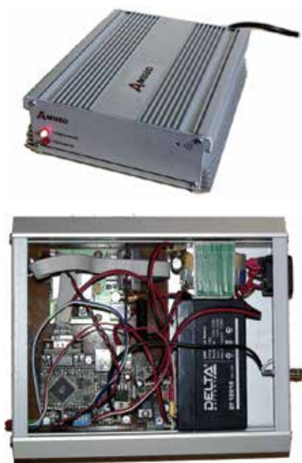
Рис. 1. Внешний вид и устройство транслятора сигналов «Амиго»
