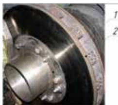
Рис. 15. Опытный образец тормозного диска 744, предназначенный для установки на ось колесной пары 1 – ступица; 2 – венец
