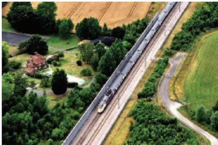
Рис. 2. Высокоскоростная железнодорожная линия с шумозащитным экраном
