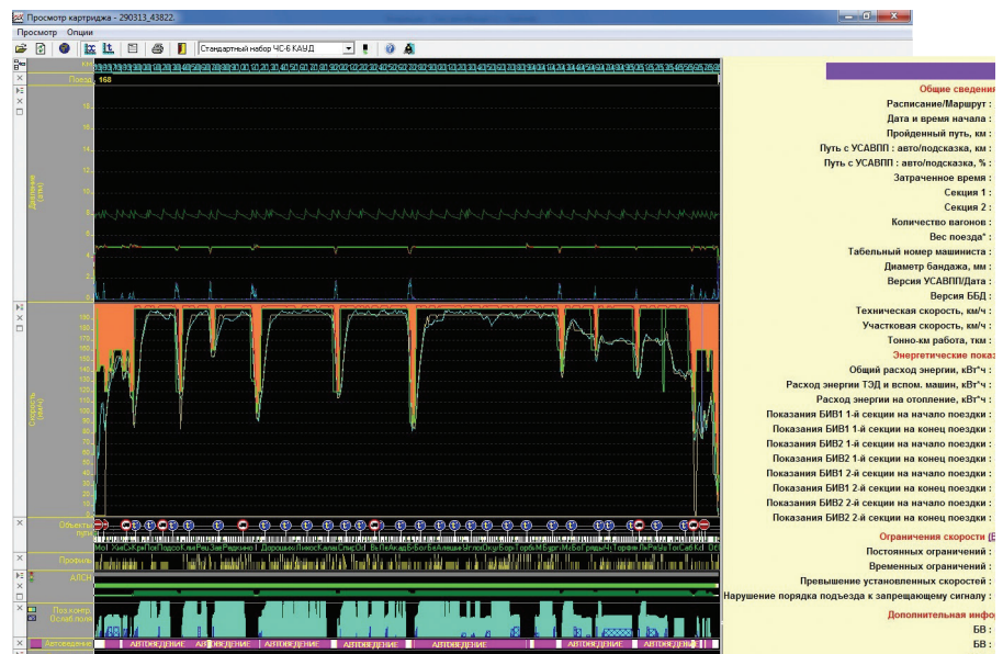
Рис.1. Графическое представление расшифровки информации, записанной во время поездки поезда №168 регистратором РПДА-П
