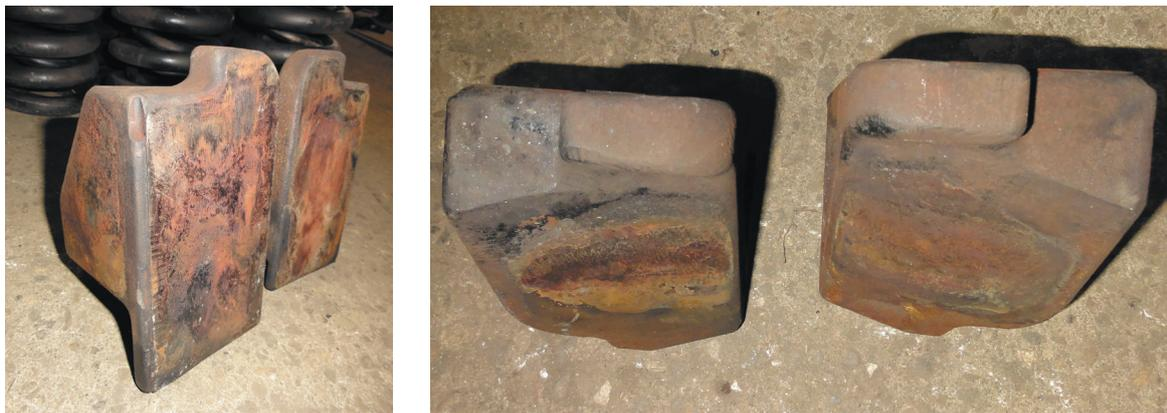
Рис. 2. Рабочие поверхности составного фрикционного клина: слева – вертикальные, справа – наклонные
