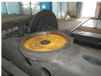
Рис. 4. Вкладыш на опорной поверхности подпятника
