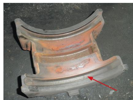
Рис. 8. Цилиндрическая поверхность адаптера для опирания на подшипник с канавкой (индикатором износа)
