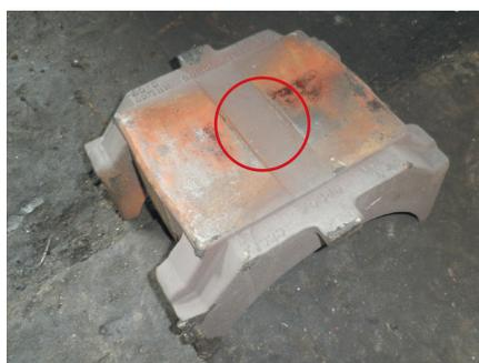
Рис. 7. Вертикальная поверхность адаптера под боковую раму с углублением (индикатором износа)
