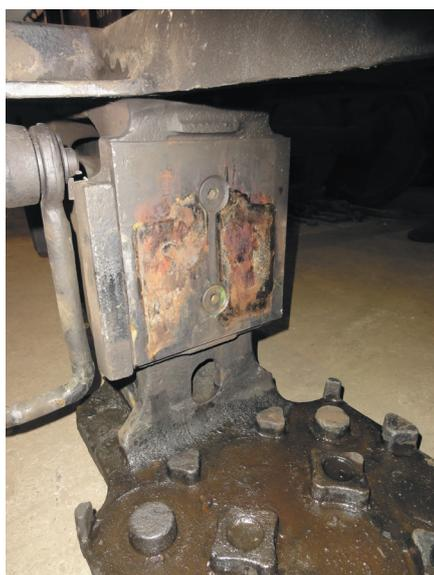
Рис. 3. Фрикционная планка, взаимодействующая с вертикальными поверхностями фрикционного клина
