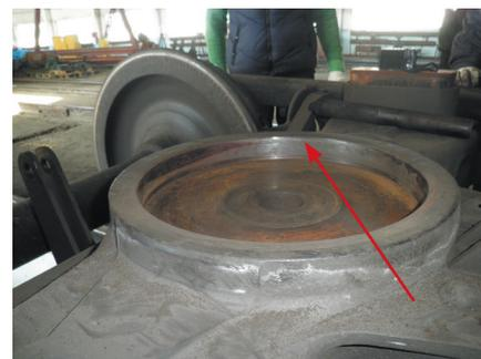
Рис. 5. Подпятник с сварным износостойким кольцом для защиты внутренней упорной поверхности бурта
