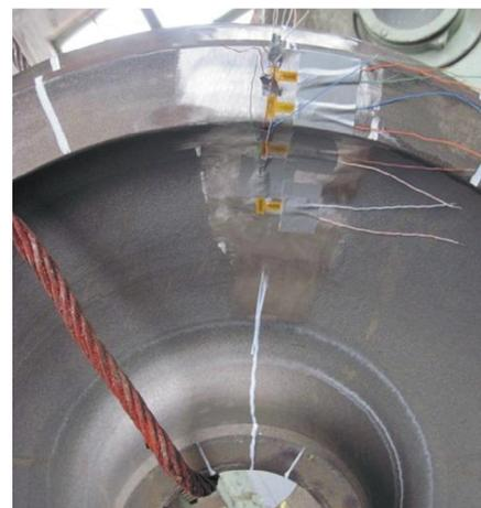
Рис. 3. Расположение измерительных схем на колесе с размеченным сектором для последующего отделения огнем способом
