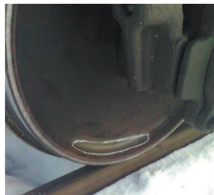
Рис. 1. Усталостная трещина колеса в зоне перехода плоскоконической дисковой части в обод длиной 200 мм после семи лет эксплуатации
