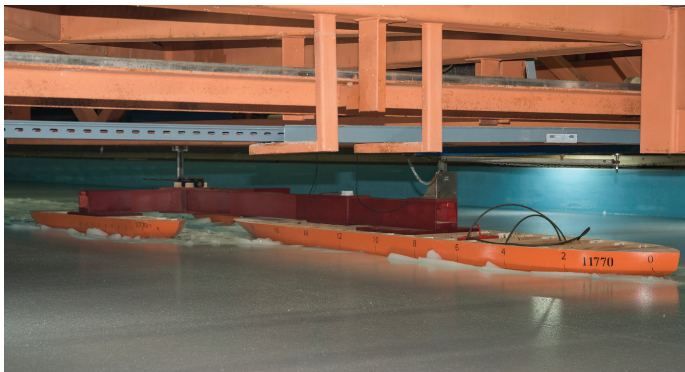
Рис. 3. Испытания трехкорпусного варианта нового ледокола в ледовом бассейне КГНЦ
