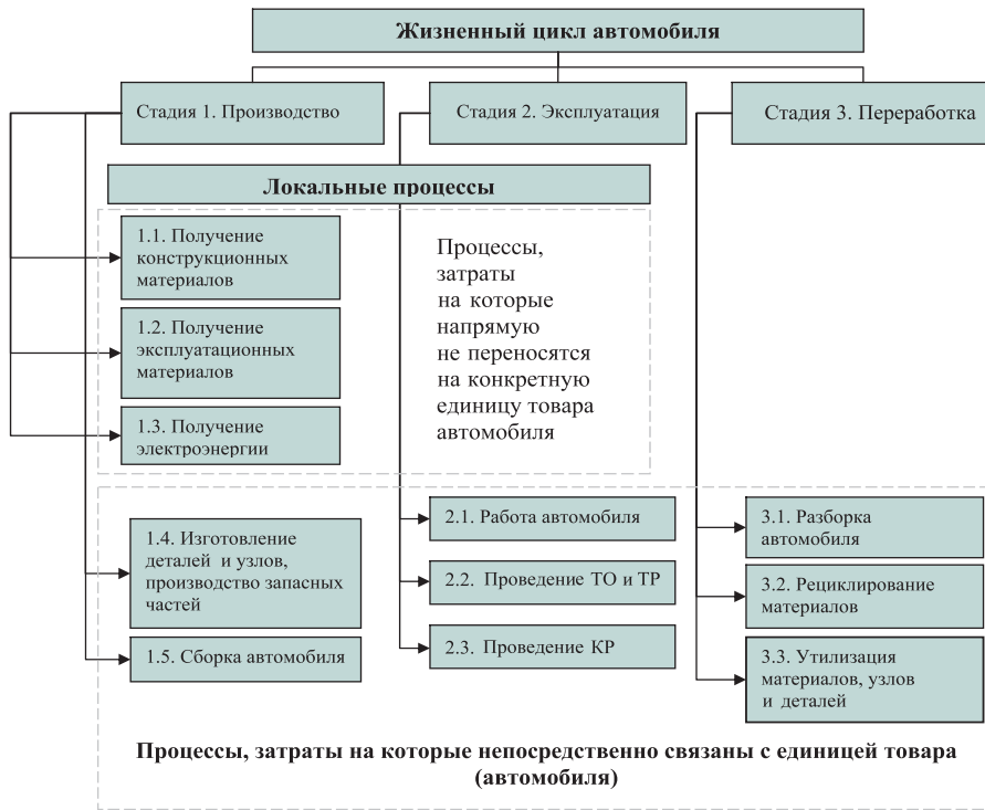
Рис. 1. Стадии жизненного цикла автомобиля: КР – капитальный ремонт, ТР – текущий ремонт
