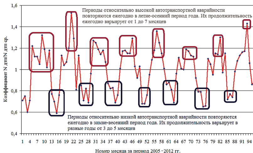
Рис. 2. Изменение коэффициента сезонности числа ДТП с жертвами и периоды относительно высокого и низкого травматизма
