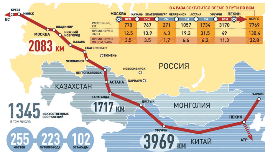
Рис. 4. Проект высокоскоростного транспортного коридора «Шелковый путь»
