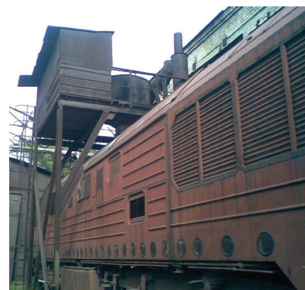
Рис. 2. Система селективного каталитического восстановления на реостате ПО «Ворошиловградтепловоз»
