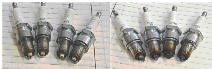
Рис. 5. Свечи зажигания испытуемого (слева) и контрольного (справа) двигателей
