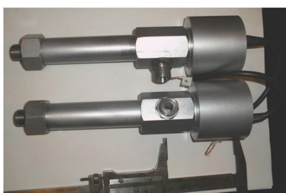
Рис. 1. Модификаторы для автомобильного двигателя мощностью до 330 кВт (слева) и судовых двигателей (справа)
