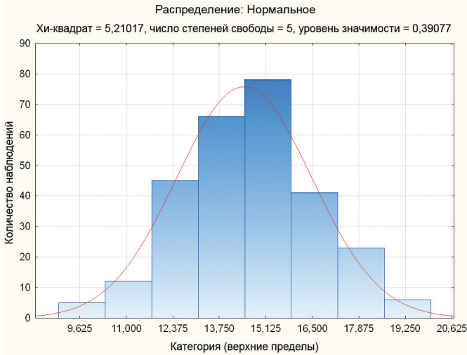
Рис. 1. Результаты аппроксимации эмпирического распределения продолжительности окончания формирования одногруппного или двухгруппного состава с использованием двух путей для накопления вагонов на сортировочной станции
