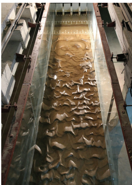
Рис. 1. Грядовая форма движения донных наносов в нижнем бьефе гидроузла (экспериментальные исследования на физической модели)
