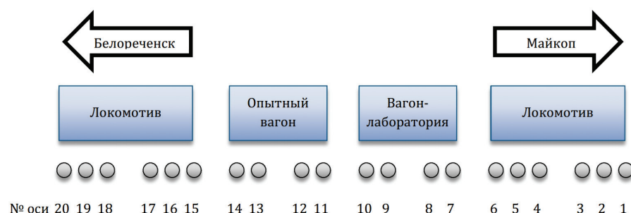
Рис. 4. Схема опытного сцепа для проведения испытаний по воздействию на железнодорожный путь
