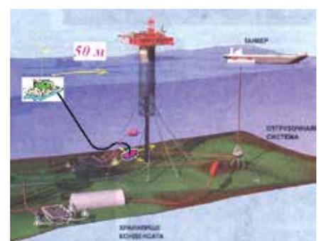
Рис. 5. Использование платформы в режиме обследования состояния устья скважины добывающей платформы
