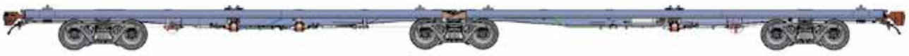
Рис. 8. Сочлененный вагон-платформа модели 13–9894 с конструкционной скоростью 140 км/ч; грузоподъемность 89,5 т; масса тары 30,5 т
