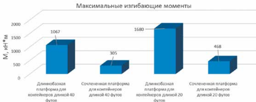
Рис. 3. Максимальные изгибающие моменты в раме вагона-платформы от веса брутто контейнеров 20 и 40 футов
