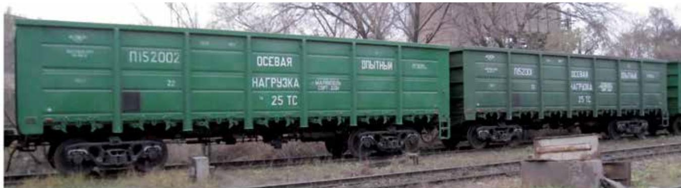
Рис. 1. Полувагоны модели 12–1905 на тележках модели 18–1711 с разной конструкцией клиньев рессорного подвешивания
