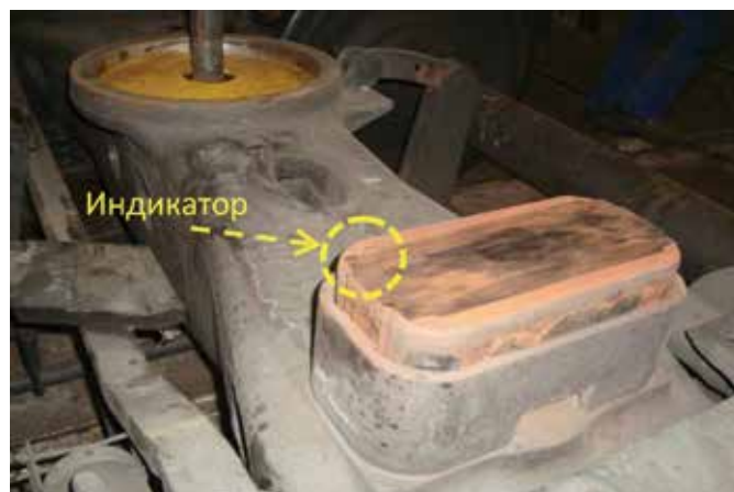
Рис. 10. Индикатор износа колпака скользя
