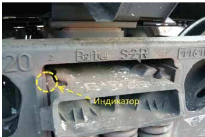
Рис. 9. Индикатор износа фрикционного клина
