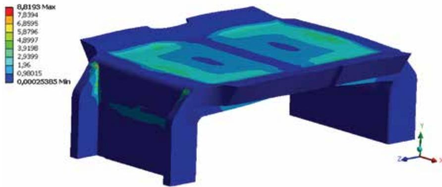
Рис. 11. Величина эквивалентных напряжений в МПа для вертикальной нагрузки 5 тс, вид сверху
