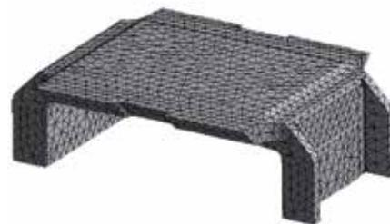
Рис. 3. Конечно-элементная модель вставки адаптера
