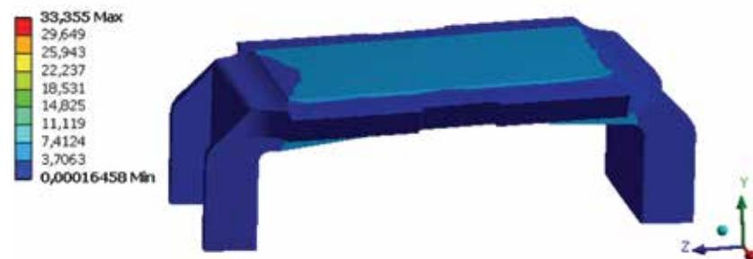
Рис. 9. Величина эквивалентных напряжений в МПа для продольной нагрузки 5 тс, вид сверху
