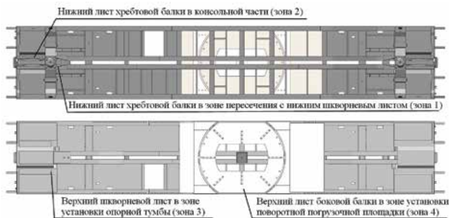
Рис. 2. Наиболее опасные зоны в конструкции вагона
