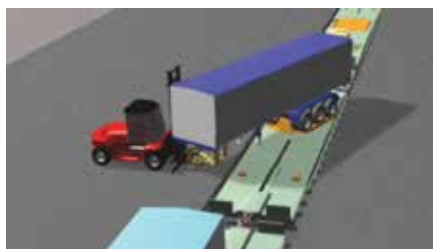
Рис. 5. Установка опоры под полуприцеп
