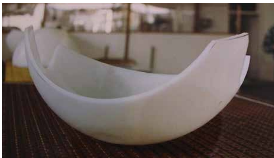
Рис. 3. Пример прокладки подпятника из TIVAR®1000
