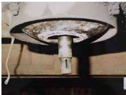
Рис. 6. Подпятник с прокладкой из TIVAR®. Нет необходимости в консистентной смазке и обслуживании
