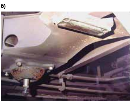
Рис. 7. Установка боковых пластин скольжения, компенсирующих свободный ход люльки (а); пластины скольжения для компенсации зазоров люльки (б)
