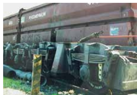
Рис. 10. Применение пластин скольжения фиксатора оси
