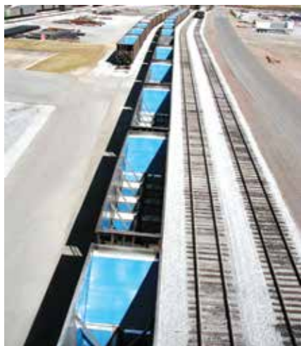
Рис. 1. Вагоны, полностью облицованные TIVAR®88
