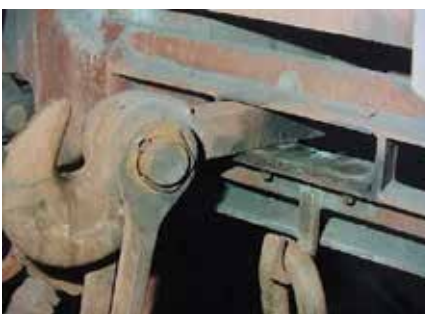
Рис. 9. Пластины скольжения в применении для тягового крюка
