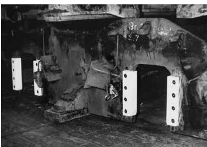
Рис. 11. Пластины скольжения фиксатора оси во время монтажа
