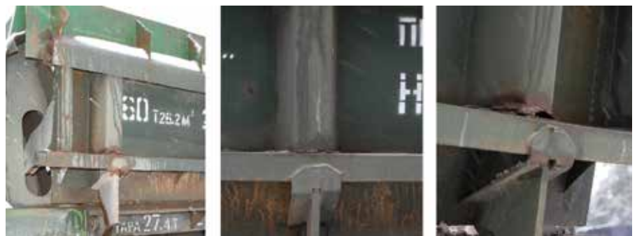
Рис. 4. Обрыв штампованных стоек продольного борта
