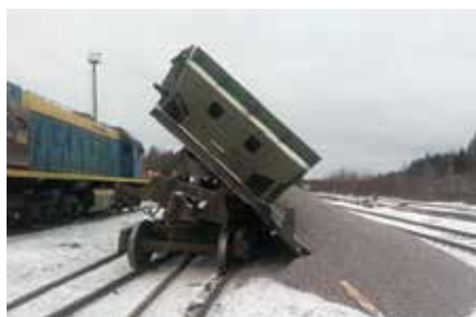
Рис. 8. Саморазгрузка думпкара в связи с неисправностями кузова
