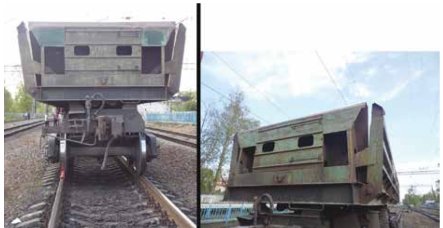
Рис. 3. Зазор между полом кузова и продольным бортом
