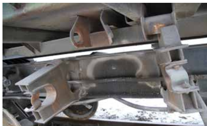
Рис. 4. Обрыв штампованных стоек продольного борта
