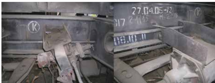
Рис. 6. Обрыв подвесного тормозного оборудования
