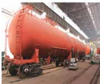
Вагон-цистерна для бензина объемом 192 м<sup>3</sup> (ОАО «Рузхиммаш»)
