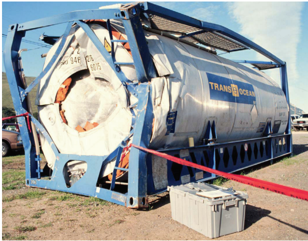
Рис. 1. Контейнер-цистерна, получивший повреждения при аварии
