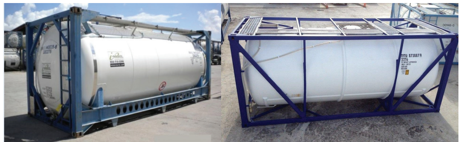
Рис. 4. Контейнеры-цистерны рамной системы
