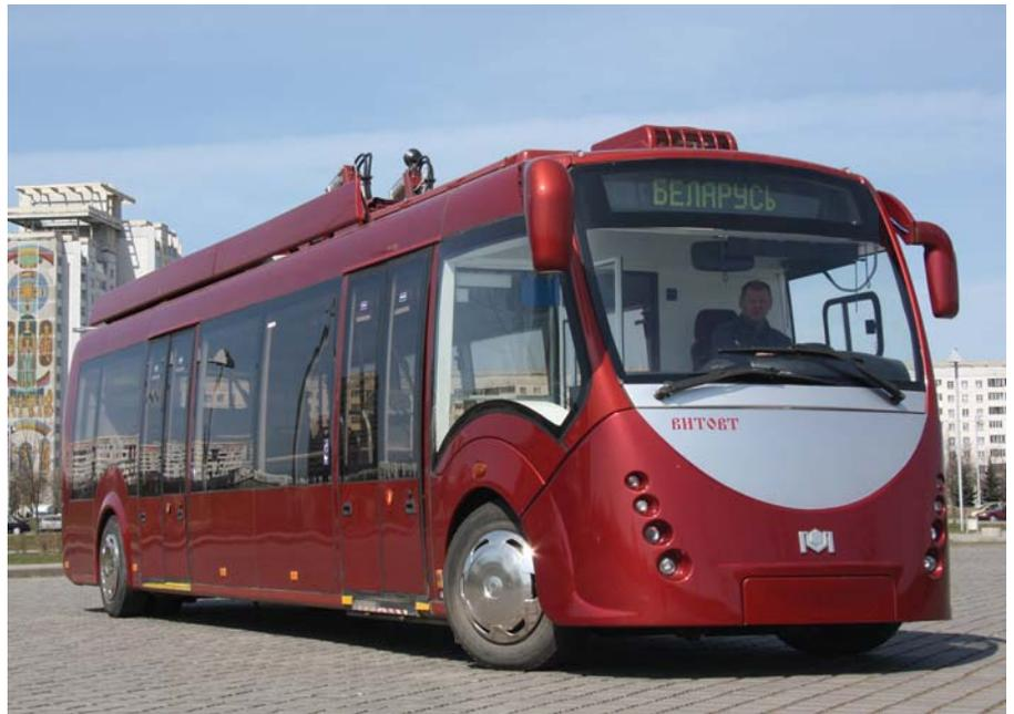
Рис. 2. Троллейбус четвертого поколения модели 42003 — «Витовт»
